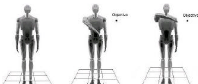
Figura 4 – Modelo movimentando a mão para junto do objectivo, utilizando a cinemática inversa, com imposição dos constrangimentos dos ângulos de junção do ombro e cotovelo. (Imagem original em: “Specialised Constraints for an Inverse Kinematics Animation System Applied to Artuculates Figures”, N. Madhavapeddy and S. Ferguson)
