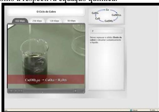
**Figura 12** – Decomposição do hidróxido de cobre (II) a óxido de cobre (II) e respectiva equação química.
