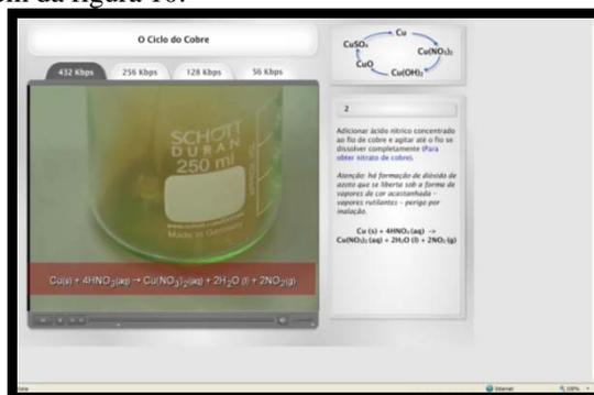
**Figura 10** – Formação do nitrato de cobre (II) com a respectiva equação química da reacção.
