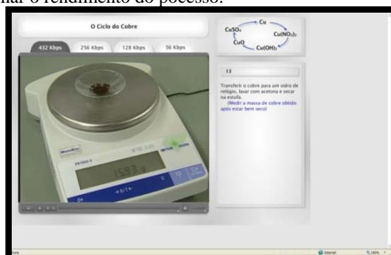
**Figura 16** – Medição da massa de cobre final, após decorrido todo o ciclo.
