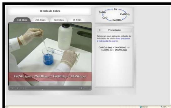
**Figura 11** – Formação do hidróxido de cobre (II) com a respectiva equação química da reacção.
