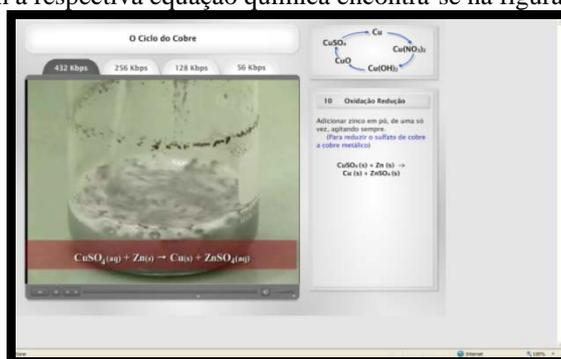
**Figura 15** – Redução do sulfato de cobre (II) a cobre metálico.
