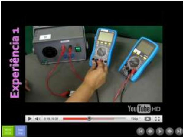
Figura 2 – Laboratório virtual (Lei de Ohm)
