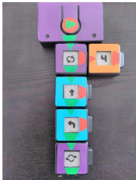
Figura 3. Sequência de blocos para o robot efetuar um quadrado
